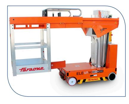
Maschine entspricht den europäischen Normen für fahrbare Hubarbeitsbühnen nach EN 1723-1/UNI EN 1726-2, mit CE- & TÜV- Zertifizierung und Zulassung für den Betrieb in Innenbereichen bei Windstille
